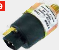
SENSOR DE PRESIÓN DE AIRE DE 0 A 10 BAR CON ALARMA EN 4.9 DOS CONTACTOS
